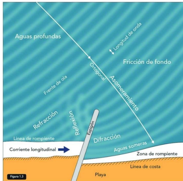
Figura 1. Efectos causados por el oleaje.
